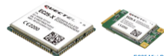
EC25 Mini PCIe 51.0mm × 30.0mm × 4.9mm
