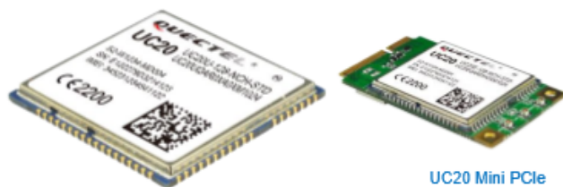
UC20 Mini PCIe 51.0mm × 30.0mm × 4.9mm
