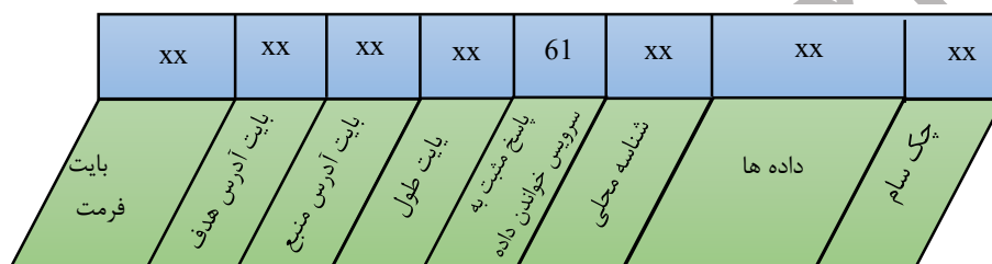
شکل 65- ساختار پیام خواندن داده با شناسه محلی حضور در KLine.
