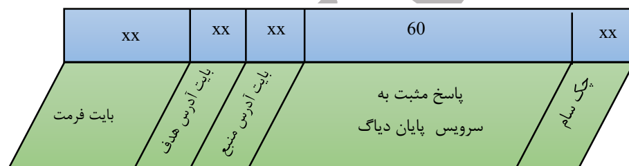
شکل 50- ساختار پیام جواب مثبت به درخواست پایان سشن در KLine.
