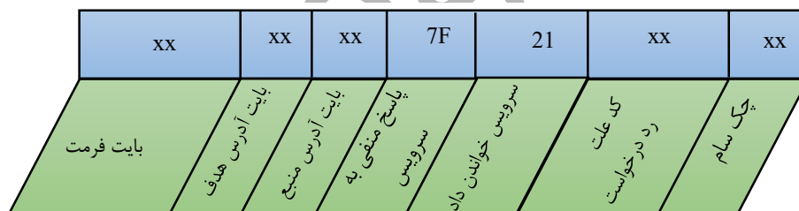
شکل 66 - ساختار پیام جواب مثبت به درخواست دسترسی به مشخصات در KLine.
