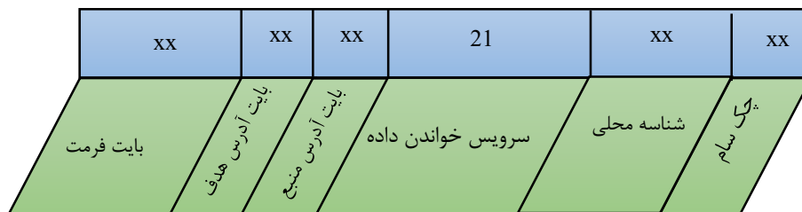
شکل 65- ساختار پیام خواندن داده با شناسه محلی حضور در KLine.
